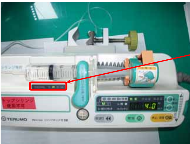
クランプでシリンジを固定する 『シリンジ ml』表示ランプの点灯数字と使用するシリンジサイズが合っているか確認する！
